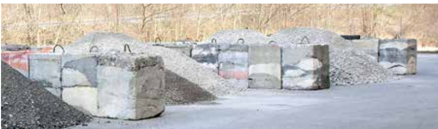
Betongranulat in diversen Fraktionen
